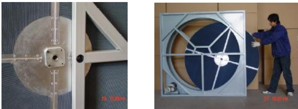
6. 在转轮底部加上合适的垫块，将转轮慢慢地从箱体中向外滚出来。
